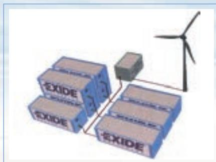
Основная концепция модульных батарейных систем накопления и хранения электроэнергии – простое конфигурирование за счет применения унифицированных «строительных единиц». В качестве «строительных единиц» выступают укомплектованные аккумуляторными батареями 20- или 40-футовые морские контейнеры стандартного объема. Они позволяют наращивать параметры системы в пределах:
