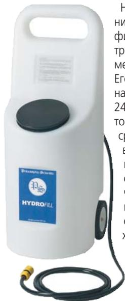
HydroPure – деионизатор на основе фильтрующего картриджа с ионообменными смолами. Его ресурс рассчитан на получение около 2400 литров подготовленной воды (при средней жесткости воды). Чистота воды анализируется при помощи датчика электропроводности, который оповестит о необходимости замены картриджа при выработке его ресурса. Система подключается прямо к водопроводной магистрали и не требует подключения к электричеству.
