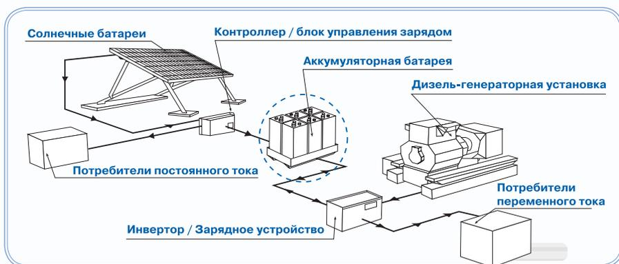
Типовая схема энергетической установки с использованием энергии солнца и ветра состоит из фотоэлектрической панели, вырабатывающей электричество постоянного тока при освещении солнечным светом, блока управления напряжением и током панели, аккумуляторной батареи, системы управления режимом заряда батареи, DC-AC конвертора, преобразующего постоянное напряжение в переменное для питания потребителей переменного тока. Система может быть дополнена ветрогенератором с
