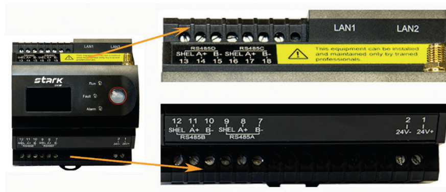
Рисунок 9. Смарт контроллер SBAT-GATE. Клеммы для подключения
