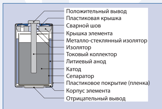
Рис. 1 Устройство литиевой батареи.
